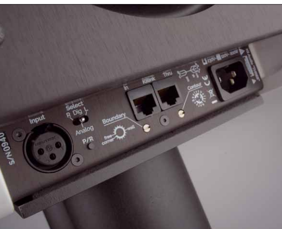
An der Kii Three dient ein XLR-Eingang wahlweise als analoger oder als digitaler Anschluss, der je nach Wunsch umgestellt werden kann. Zwei kleine Drehregler erlauben das Justieren der Klangregelung
